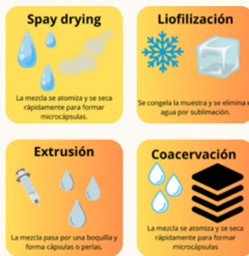
Figura 2. Principales métodos de encapsulación empleados en la industria. Fuente: creación propia (Canva).
